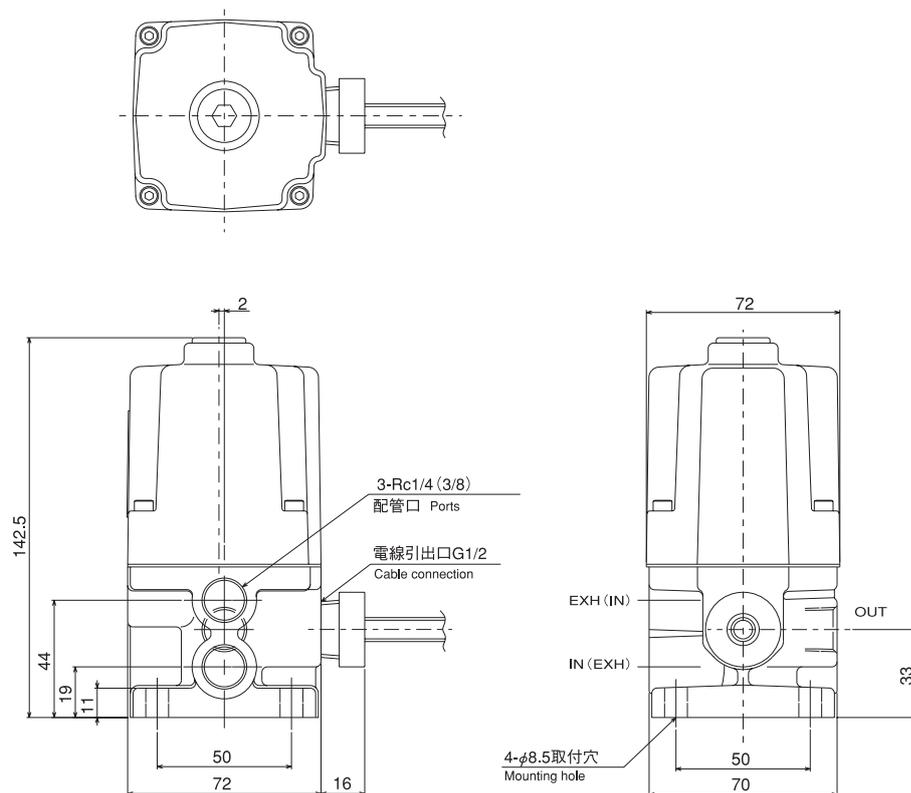
●常時開形の場合配管ポートは( )内指示ようになります。 Ports for NO type valve piping are specified in parentheses.
