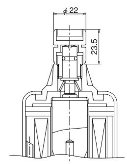
注) UY形およびWY形手動押ボタンを複動形電磁弁に、ご使用になることは極力避けてください。ロック解除を忘れるとコイルの焼損を招きます。
